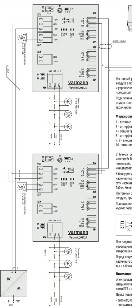
Настенный регулятор Vartronic 703201/703202 осуществляет регулирование температуры воздуха в помещении посредством плавного изменения скорости вращения вентиляторов и управления термоэлектрическим сервоприводом для изменения расхода теплоносителя, проходящего через теплообменник конвектора.
