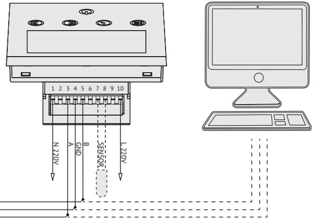
В блоках регулирования Vartronic 201115 используется совместимый последовательный интерфейс RS-485. Блоки регулирования соединяются, используя технологию «главный-подчиненный», при которой только одно устройство (настенный регулятор или HOST-PC) может инициировать передачу данных и делать запрос.
