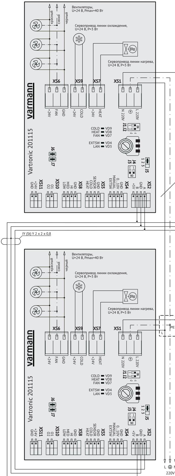
Настенный регулятор Vartronic 703201/703202 осуществляет регулирование температуры воздуха в помещении посредством плавного изменения скорости вращения вентиляторов и управления термоэлектрическим сервоприводами линий нагрева и охлаждения для изменения расхода теплоносителя, проходящего через теплообменник конвектора.
