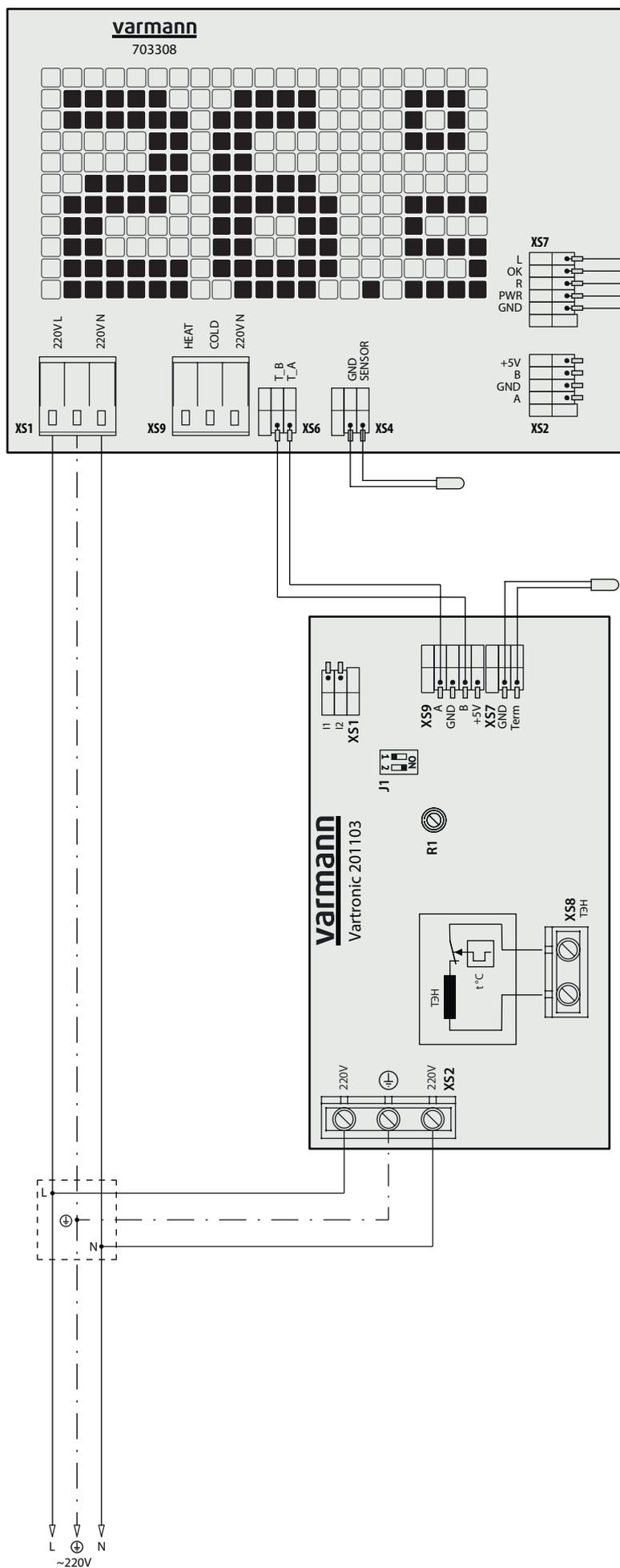
Регулирование нагревом ТЭН осуществляется в автоматическом режиме силовой платой управления Vartronic 201103 в зависимости от установленной температуры воздуха на электронном блоке 703308.
